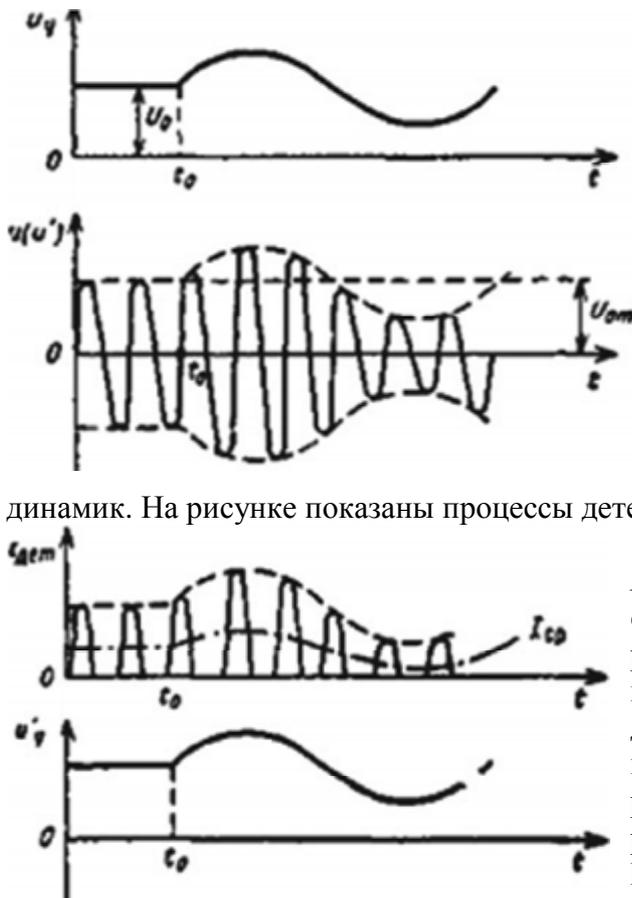
На рисунке показаны процессы детектирования (демодуляции) и сглаживания.
